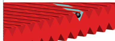
• **Elemento filtrante de malla**, fabricada en acero inoxidable con estructura en plástico técnico.
